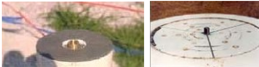
Слика 2.23: Бетонски стуб са фиксно постављеним централним завртњем
