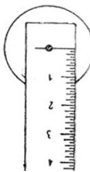
Слика 4.11: Постављање лењира када је визура испод рупице
