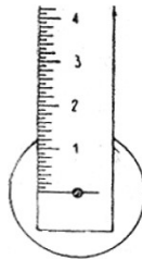
Слика 4.10: Постављање лењира када је визура изнад рупице
